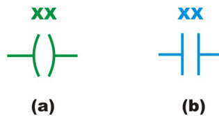
Figura 5.2: Saída e Entrada em Ladder
